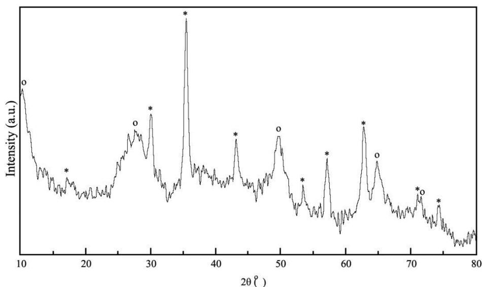
**Fig. 3.** XRD pattern of a) Fe@B ( $\text{Fe}_3\text{O}_4$ : \* and boehmite: o).
